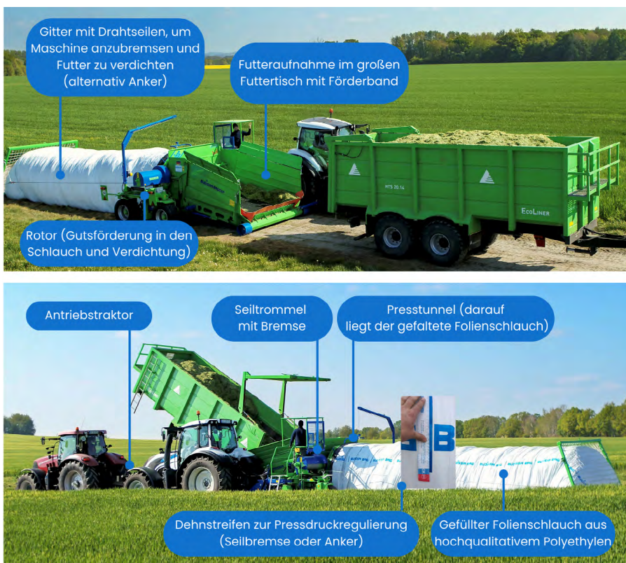
Abb. 1: Funktionsschema einer Schlauchpresse mit Gitter (Quelle: Firmendarstellung Budissa, 2023)
