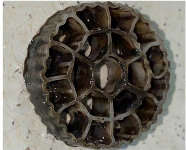
**Bild 3:** Beispielhafte Trägerkörper (links  $\varnothing \approx 40$  mm; rechts  $\varnothing \approx 25$  mm) mit anaerobem Biofilm
