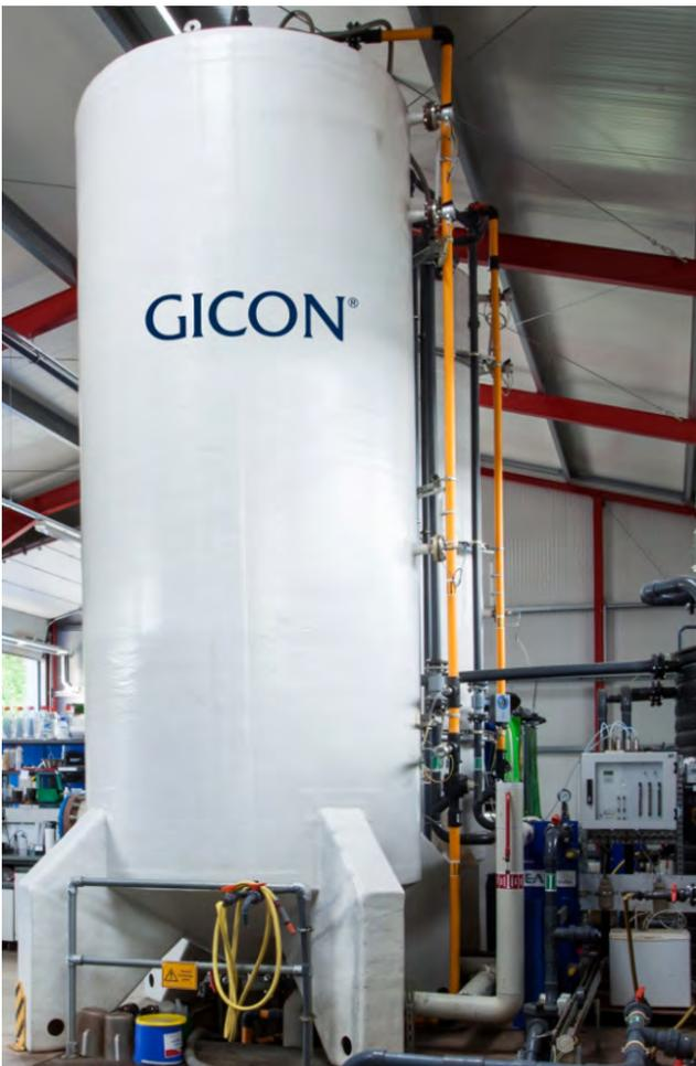
Neben verschiedenen kleintechnischen Testanlagen ( $V =$  bis 80 L) wurde das Verfahren auch in drei großtechnischen Testanlagen ( $V = 1$  bis  $10\text{ m}^3$ ) umgesetzt (Bild 4).
